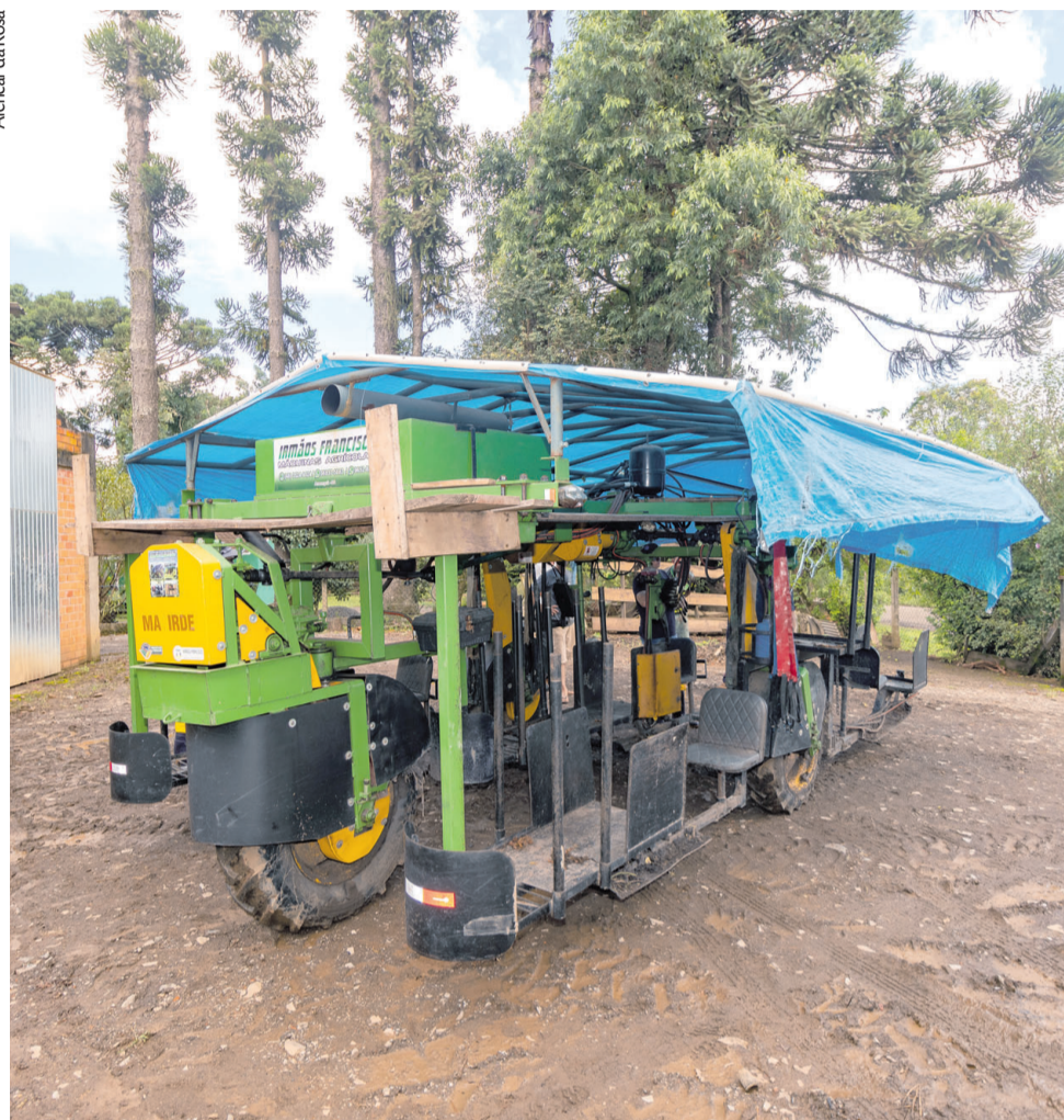
Matirde possibilita o trabalho de quatro pessoas, simultaneamente, durante a fase da colheita do tabaco
