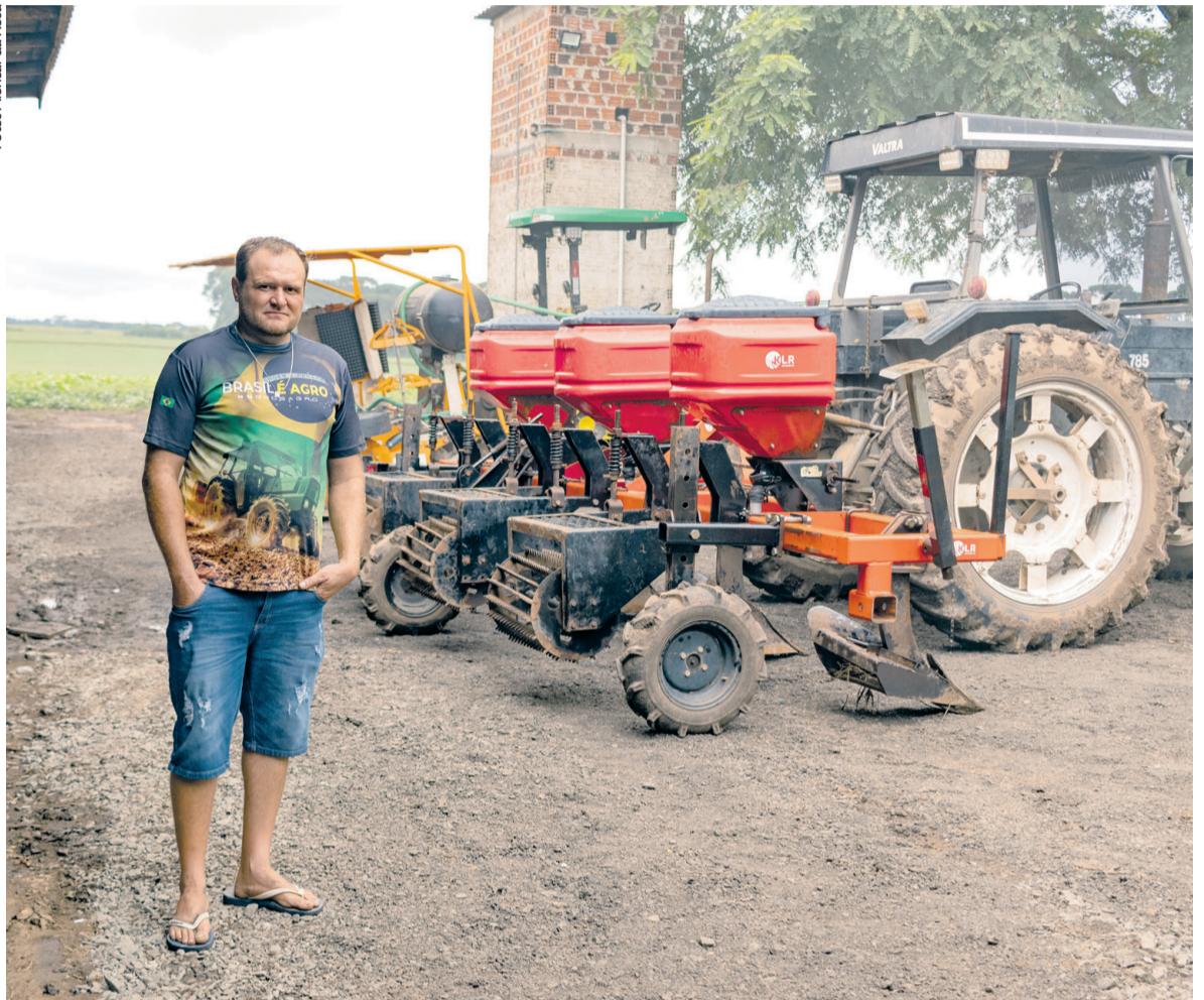
Clóvis Haman apresenta a estrutura que serve para a confecção dos camalhões, garantindo mais agilidade no processo produtivo
